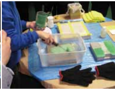
水浸しのコンクリートサンプルにローラー塗布
