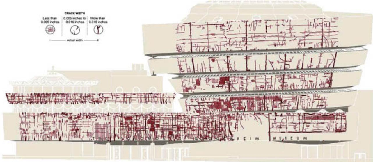
写真⑩ 美術館西面の躯体調査図。ひび割れの巾は、0.005インチ(約0.13mm)未満、0.016インチ(約0.41mm)以上、そしてその中間の3種類に分けて明記されている。（出典：The New York Times, 2007/09/10）
