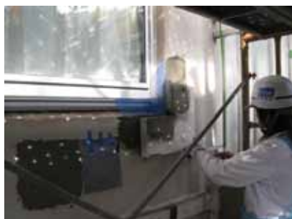
開口部下での断熱材（メッシュ）の付着強度試験
