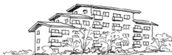
5階建てのマンションを一部3、4階建てに減築し、勾配屋根を架ける
