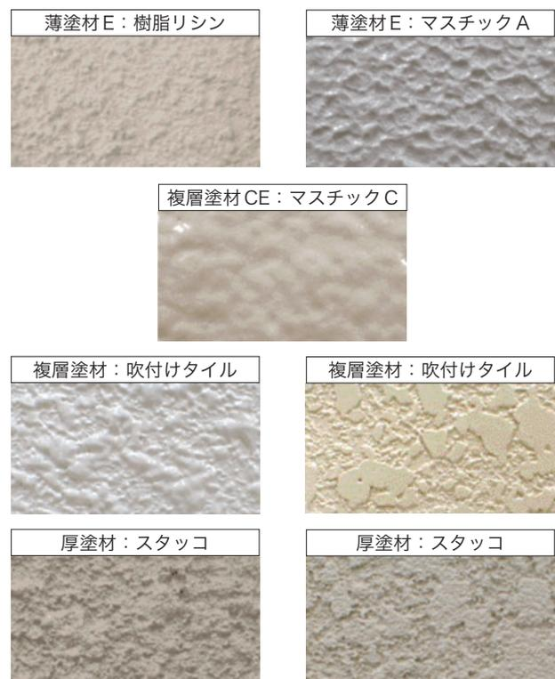
写真1 仕上塗材の例
