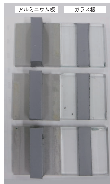
写真1 ガラス越し耐光接着性試験後の破壊状態
