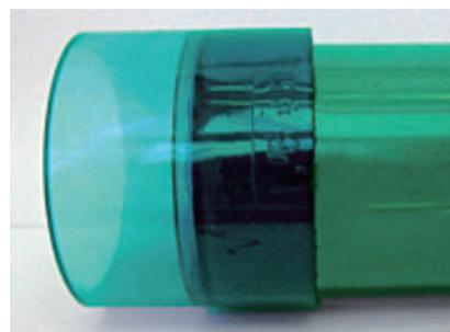
写真 5 透明継手の接合状況
