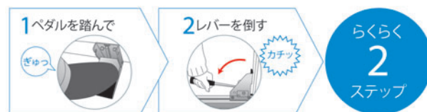
図 2 2 ステップでの設置
