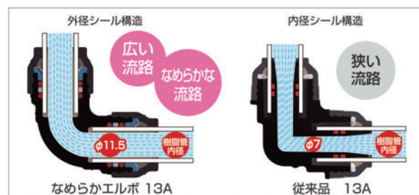
図2 エルボ継手 流路比較
