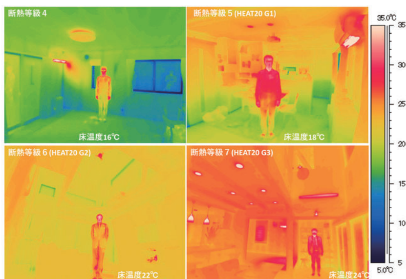
写真2 断熱等級4～7の室内を赤外線カメラで撮影
