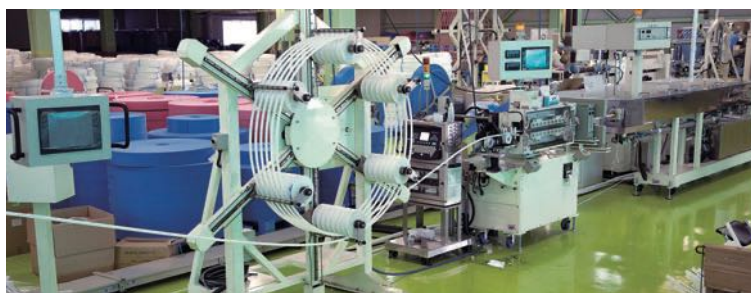
架橋ポリエチレン管押出成形
