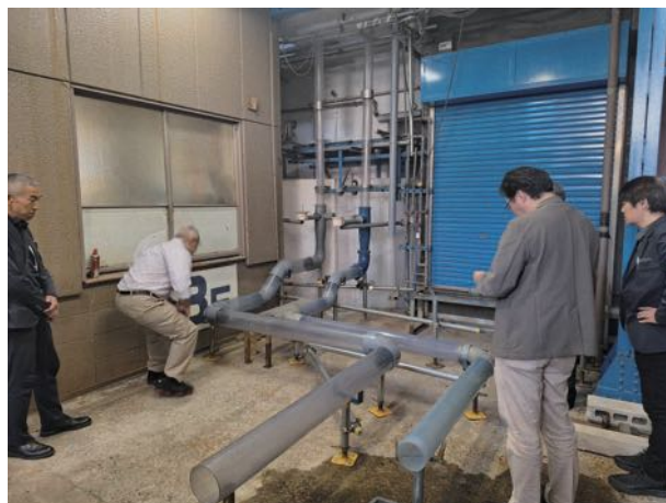
写真6 ダッキング配管実験
