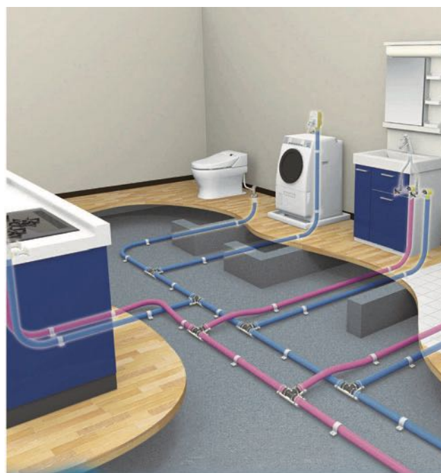
図2 新築配管イメージ
