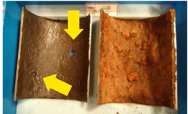
写真：排水鋳鉄管(抜管半割)
