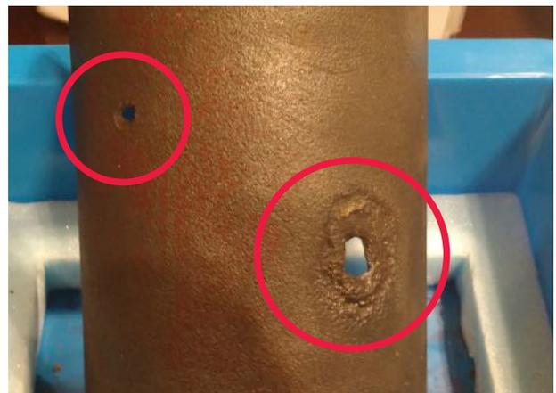
写真：排水鋳鉄管(腐食穴)
