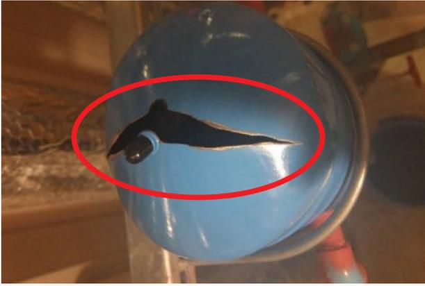
写真：ウォーターハンマ防止器（破裂）
