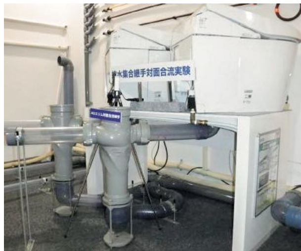
排水集合継手対面合流実験
